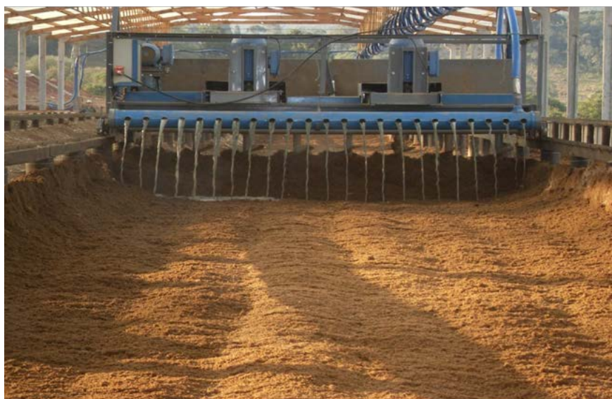
Figura 7: Plataforma automatizada de compostagem de dejetos
