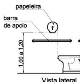
Colocação do dispenser no sanitário para PNE
