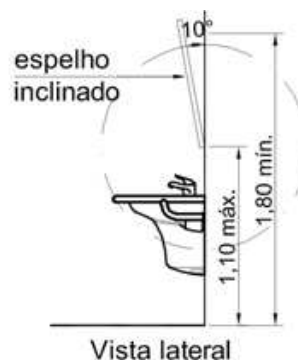
Colocação de espelho em sanitário para PNE
