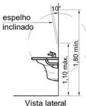
Colocação de espelho em sanitário para PNE
