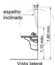
Colocação de espelho em sanitário para PNE
