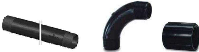
Os eletrodutos serão ser fornecidos em barras com 3m de comprimento, rosca nas duas pontas e providos de luva em uma extremidade. As curvas deverão possuir rosca e luva nas duas extremidades.
