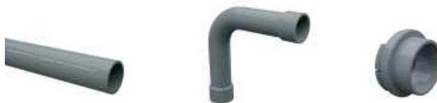
Os eletrodutos sobre o forro serão de diâmetro mínimo de 1", devendo ser fornecidos em barras com 3m de comprimento, rosca nas duas pontas e providos de luva em uma extremidade. As curvas deverão possuir rosca e luva nas duas extremidades.
