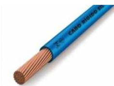
Para o circuito alimentador das tomadas destinadas a iluminação de emergência e para retorno das chaves bóias dos reservatórios, para distinção dos outros circuitos, utilizar cabo paralelo tipo Pirastic, classe de isolamento 750V e seção transversal 1,5 mm<sup>2</sup>, marca PIRASTIC ou similar.
