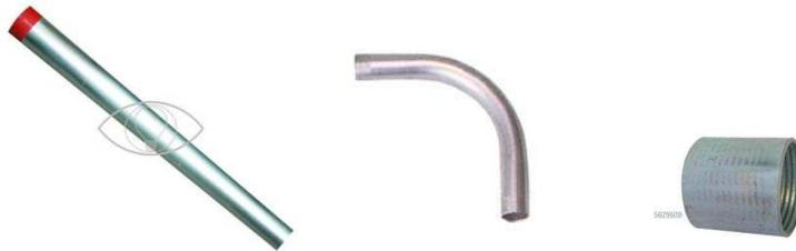
Os eletrodutos deverão ser fornecidos em barras com 3m de comprimento, rosca nas duas pontas e providos de luva em uma extremidade. As curvas deverão possuir rosca e luva nas duas extremidades.
