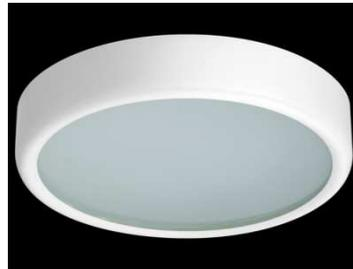
As arandelas serão do tipo tartaruga blindada, para uma lâmpada compacta de 23W , corpo em alumínio com pintura eletrostática a pó, na cor branca e vidro canelado. Referência 21000019, marca Startec ou similar. Aplicação reservatório superior.
