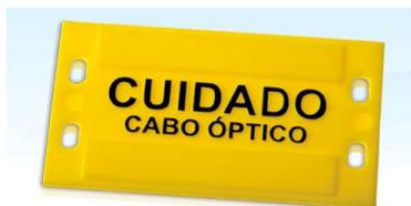
As plaquetas devem ser fixadas individualmente nos cabos, a cada 20m percorridos e nos pontos de entrada dos pavimentos, no interior de caixas de passagens e no interior dos racks de distribuição.
